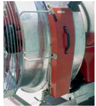
Hydraulische anti-Abdrift verschiebbar Luftleitblech. Geschlossen
