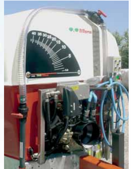
Vorderansicht mit dem größerem mechanisch Tankanzeiger und die große Ansaugenspülvorrichtung.
