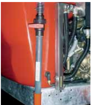
Die große (1"-1/4) Ansaugenspülvorrichtung für chemische Pulver. Sie wird im Einfüllsieb abfließen, nicht direkt im Behälter !
