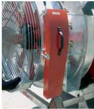
Hydraulische anti-Abdrift verschiebbar Luftleitblech. Geöffnet
