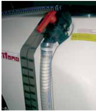
Das Aktionventil des Super-Mixer-F3 für die Pulver fast Mischung.
