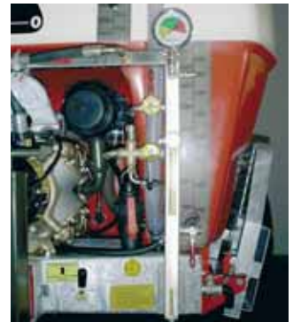
Ansaugfilter, Hochdruckrührwerkeventile, 4-Leitungen Multi-Löcher Rührwerk System, Kreislaufsspülanlage, Supermixer F3 für Pulver, Druckmessöffnung, Druckwasserventil, sind alle auf Linke Seite: Komfort und bessere Sicherheit.
