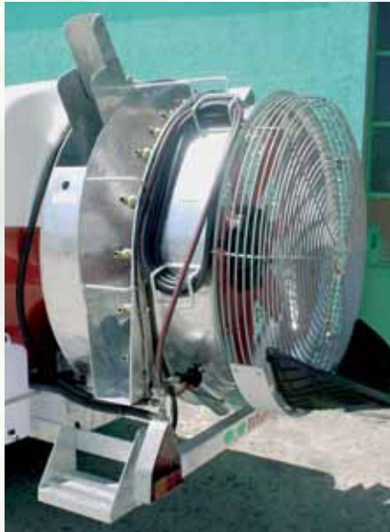
Das kräftige Biturbo Doppelkanal 42" Gebläse, mit Schlauchhaken und Pistolköcher, anti-Abdrift Düsen, beiderseitige Treppe und die verstellbare Obere Luftleitbleche der Doppelkanalsystem und das Reinwasserbehälter für Handwaschung (auf der Linke Seite).
