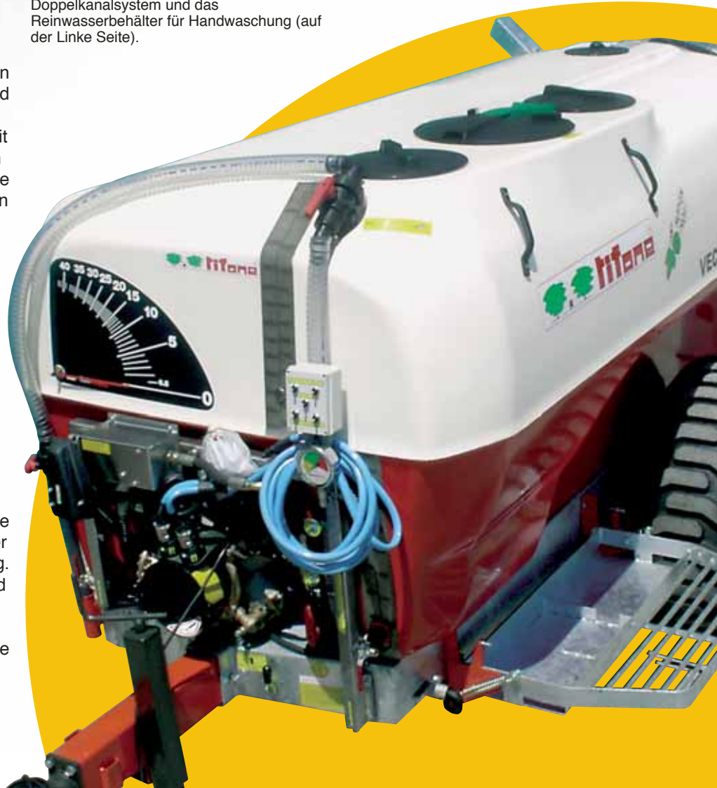
Vorderansicht mit dem größerem mechanisch Tankanzeiger und die große Ansaugenspülvorrichtung.
